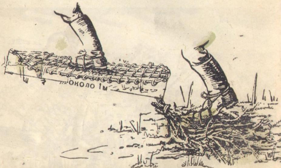
Болотоступы изготавливаются либо в виде пучка ветвей, либо в виде плетенки. Основу болотоступа-плетенки сделай из прутьев диаметром 1,5—2,0 см. Сделай прочное заплетение под ногой, остальную часть заплести редко. Для подвязывания болотоступов к ногам используй куски веревки, лыка и т. п.
